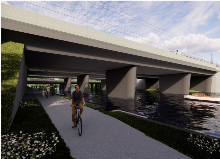
Visualisering av hur ny järnvägsbro över Stångån skulle kunna se ut med gång- och cykelväg under bron. Bilden visar exempel på en så kallad balkbro med brostöd i vattnet.
